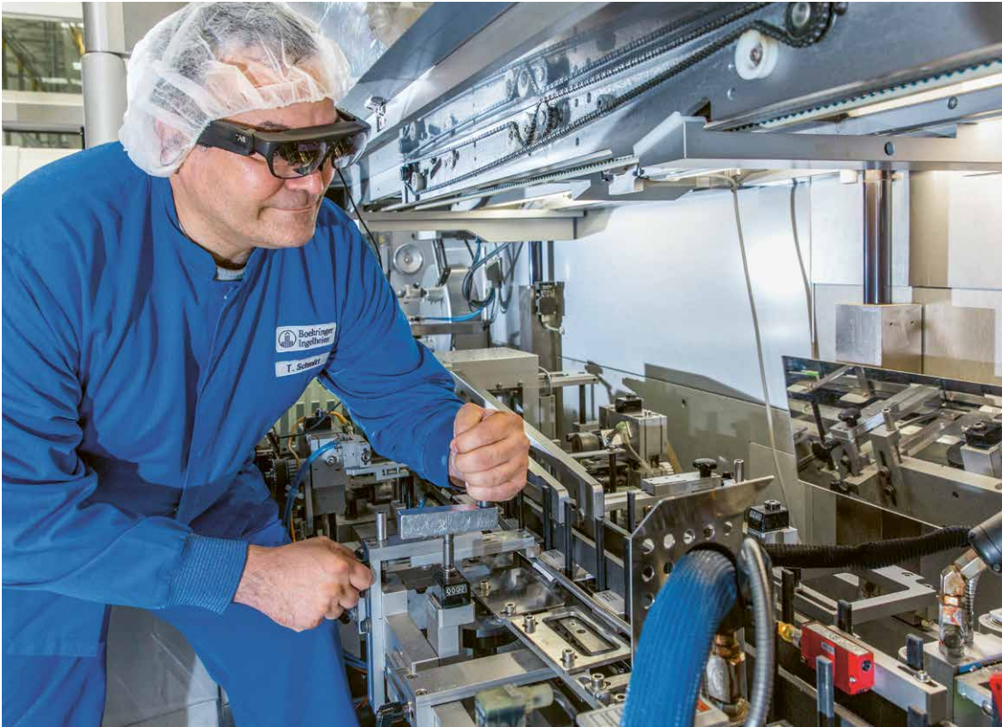
Bei Wartungsarbeiten können Produktionsingenieure über Augmented-Reality-Brillen eine Live-Verbindung zu Technikern herstellen.
