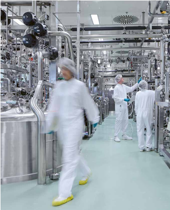
Biopharmazeutika werden in Bioreaktoren mit einem Fassungsvermögen von bis zu 15.000 Litern kultiviert.
